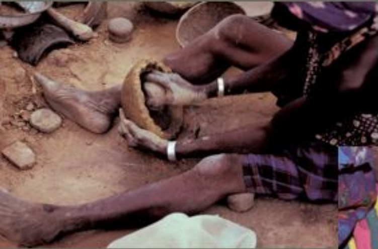
Pilonnage sur forme concave
