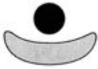
Pilonnage sur forme concave dans un moule d'argile crue
