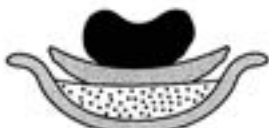
Moulage sur forme concave dans un moule d'argile cuite au-dessus d'une tournette
