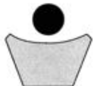
Pilonnage sur forme concave dans un moule d'argile cuite ou un creux du sol
