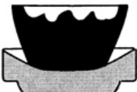
Creusage de la motte sur moule d'argile crue
