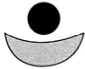
Pilonnage sur forme concave dans un moule de bois
