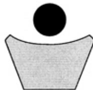
Pilonnage sur forme concave dans un moule d'argile cuite ou un creux du sol
