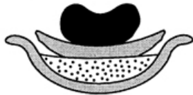
Moulage sur forme concave dans un moule d'argile cuite au-dessus d'une tournette
