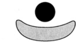
Pilonnage sur forme concave dans un moule d'argile crue
